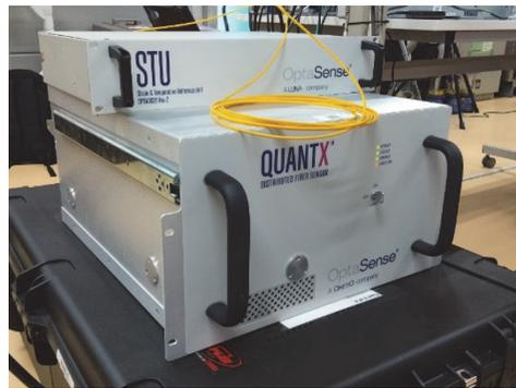
図 2 DAS計測器の例。通常19インチコンピュータラック4段から6段程度に収まるサイズである。内部にレーザー光発振装置、ファイバ、干渉計測装置などを収納しており、計測器自身の振動がノイズとなるので、注意が必要である
