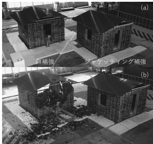
図2 実験後における試験体の様子。(a)は加振前、(b)は最終加振後。
