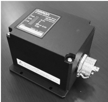
写真 2 IT強震計の1例
