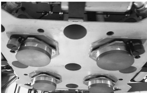
図 3 装置下面の圧縮空気を吹出す円盤
