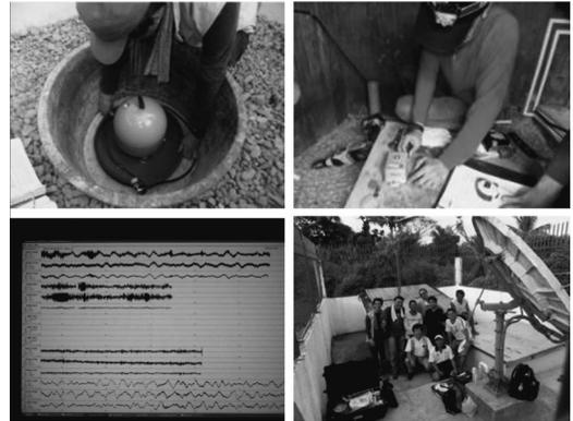
図 3 広帯域地震計と強震計の設置
