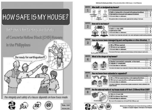
図 12 フィリピン住宅の簡易耐震診断
