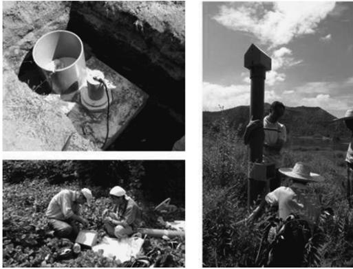
図 10 タール火山での磁力計の設置
