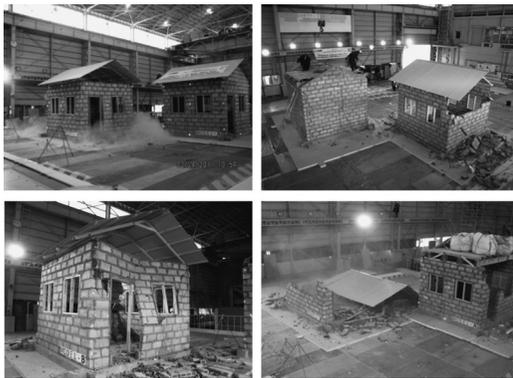
図 11 フィリピン型庶民住宅の振動台実験
