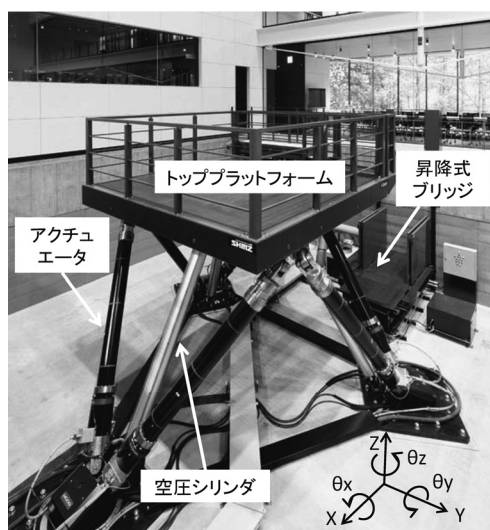
写真 2 大振幅振動台外観
