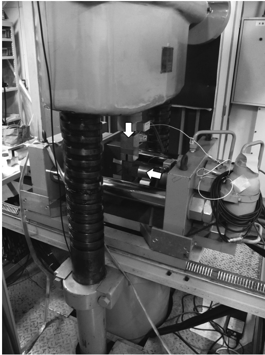
図 1 東大地震研究所に設置されている2軸圧縮試験機. 鉛直方向と水平方向のピストンにより2方向から圧縮できる
