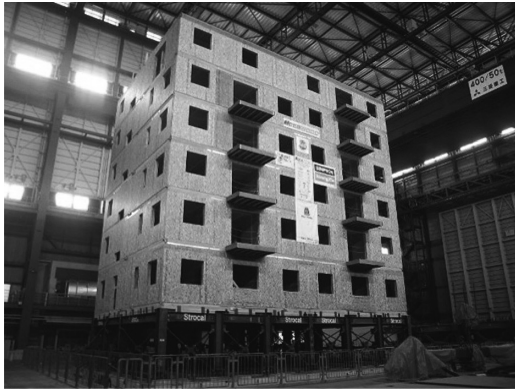
図 6 日米による7層木造建物実験
