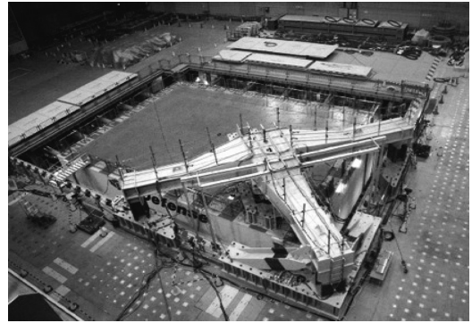
図 14 E-ディフェンスを試験装置とした免震部材の実験（全景）
