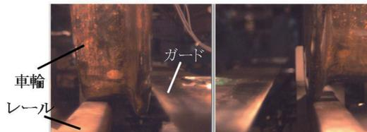
b) 車輪・レール・脱線防止ガードの拡大映像 (高速度カメラ使用)
