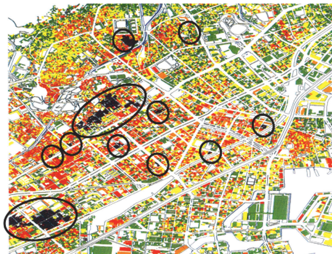
図7 阪神・淡路大震災における神戸市兵庫区での振動被害と焼失被害 (都市計画学会等(1995)の建物被害状況図から火災被害建物を筆者が集成)
