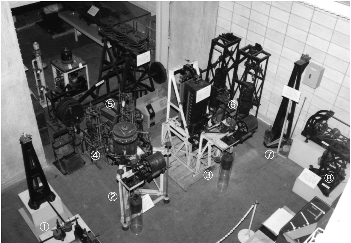
図 11 上野展示館地階での地震計の収蔵展示 (1993 年)。①大森式、②ヴィーヘルト水平動、③ヴィーヘルト上下動、④松沢式上下動、⑤マインカ上下動、⑥マインカ水平動、⑦大型大森式の支柱と振り子、⑧ガリッテン
