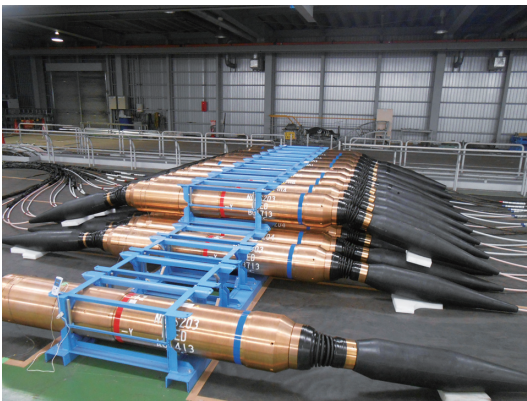
図4 本プロジェクトで開発したインライン式海底観測装置
