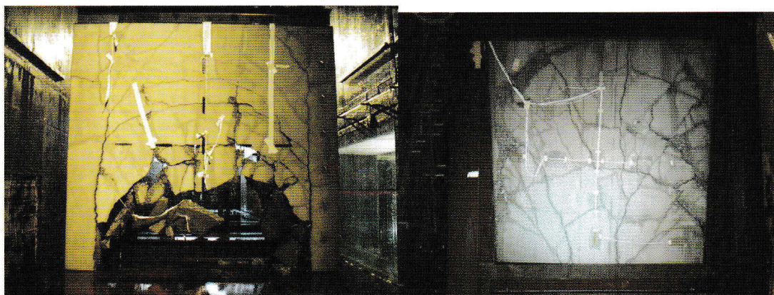
写真 6 津波の作用でコンクリート壁が破壊した様子（左図：壁厚 60 mm（正面），右図：壁厚 100 mm（背面））
