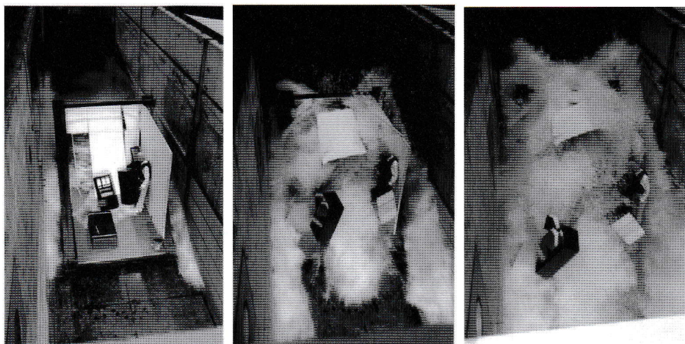
写真 5 津波力によって破壊される木造家屋壁面の一連の流れ
