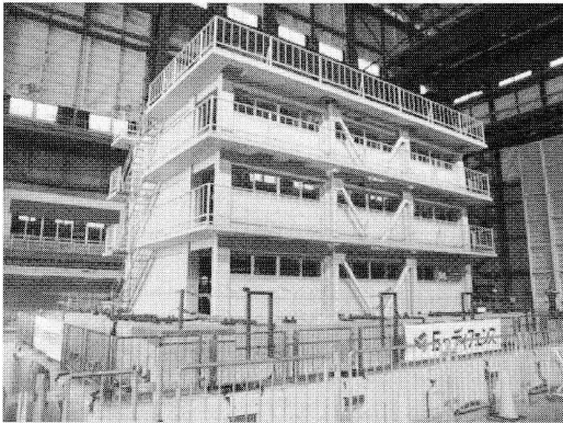
図 8 実大 3 層 RC 建物の震動台実験 (上側：無補強試験体，下側：補強試験体)
