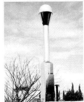
図 2 GEONET 電子基準点
