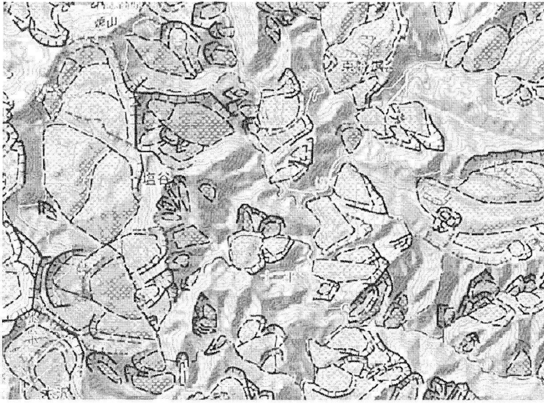
図 2 芋川周辺の地すべり地形分布図 (H: 東竹沢地すべり, S: 塩谷地すべり)
