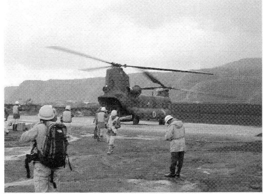
図 6 (左) 2000 年 10 月-11 月は 15 人乗りぐらいの小型漁船で、基地とする神津島から三宅島まで片道 1 時間半程度かけて観測に出かける。波シブキを浴びつつ、激しい揺れに重力計も人もひたすら耐える。(右) 12 月から一部ヘリコプターが投入されると、重力計を輸送中の振動がかなり軽減され、測定精度も大幅に向上した。
