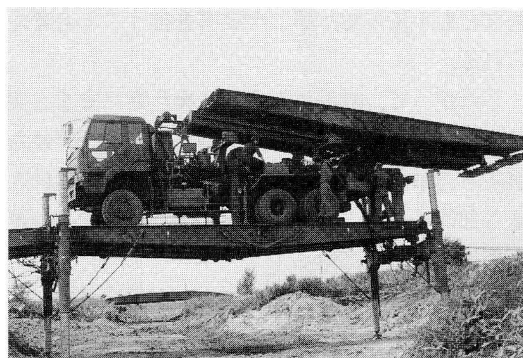
写真3 自衛隊の装備している自走式架柱橋
