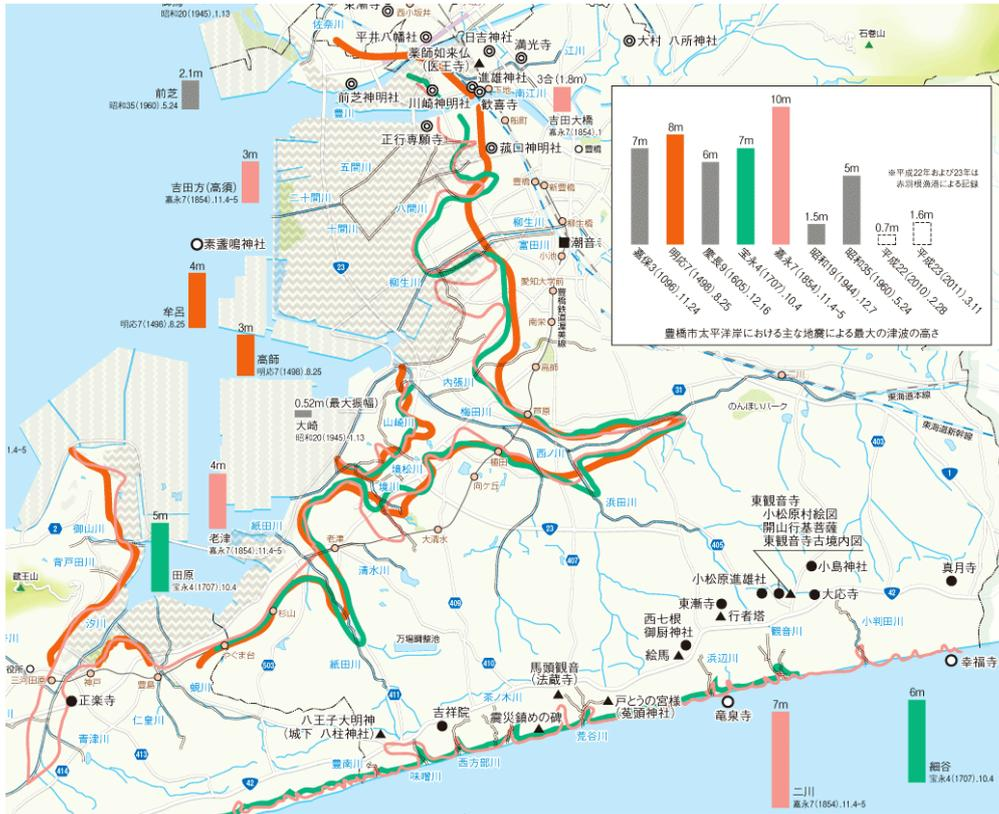
図 29: 過去の南海トラフ巨大地震で東三河地域を襲った津波の遡上分布 (豊橋市などによる)
