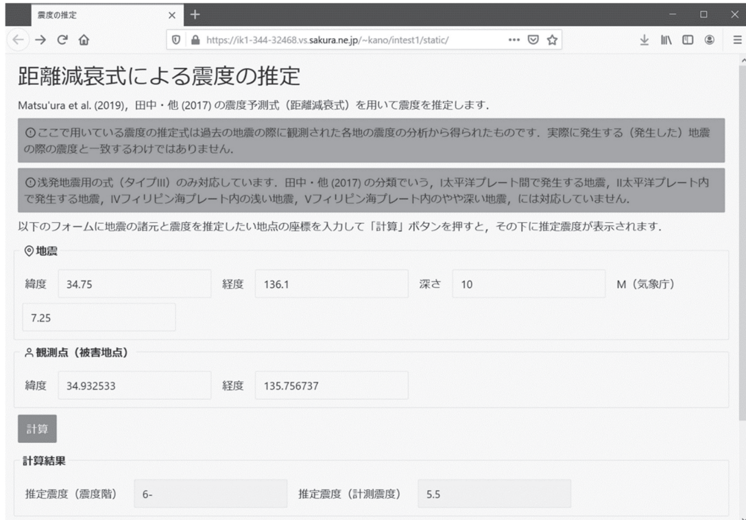
図 3. 松浦(2018)の震度予測式に基づいて震度を計算する Web アプリ。
