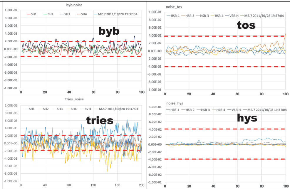
図 7. 2011年10月28日19:37'から5秒間のノイズ記録の比較.赤点線はbyb観測点の平均的ノイズレベルと相当する範囲を示す.左；byb観測点とtries観測点(歪計)右；tos観測点とhys観測点(応力計)
