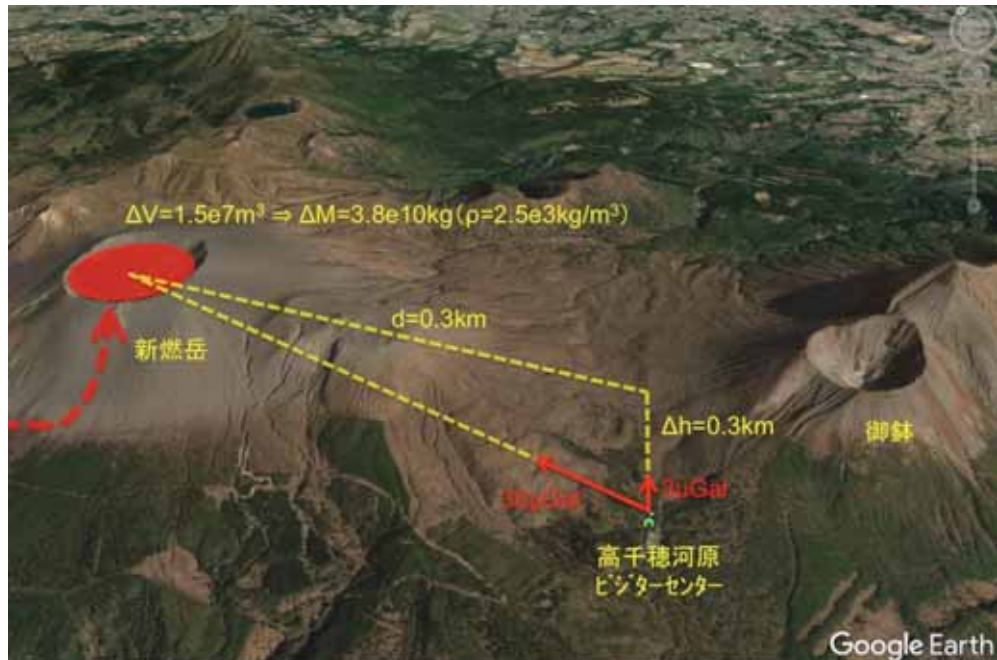
図6. 新燃岳火口内を埋めた溶岩による高千穂河原ビジターセンターにおける重力変化.
