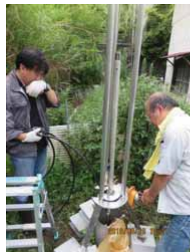
2018/8/16 に実施した地震計入れ替え作業。
