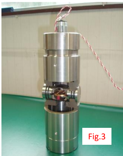
Fig.1: 開発した応力計(左)と従来の歪計(右)の外観 Fig.2: 応力計(左)と歪計(右)の内部の正面図 Fig.3: 水平1成分の応力計の写真、見やすくするために容器の半分を切り取ってある Fig.4: ボアホール総合観測装置(TOS観測点)
